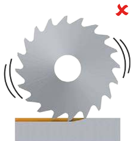
1 - 2 dents en matière Trop peu de dents = risque de vibration
