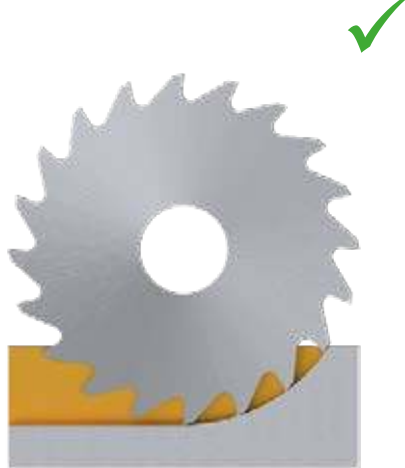
3 - 4 dents en matière = usinage stable
